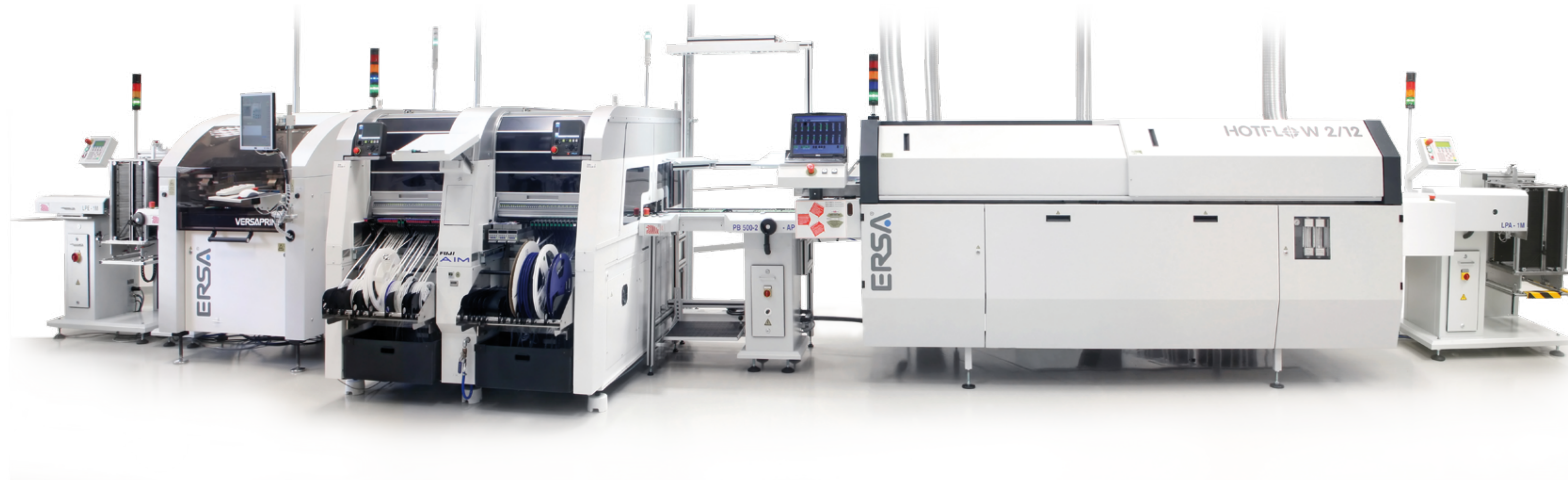
Reflowlötsystem mit flexiblem Profilmanager
