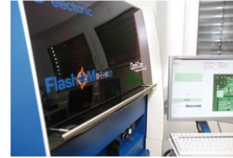
AOI (Automatische Optische Inspektion)
