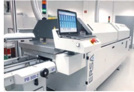
Reflowlötsystem mit flexiblem Profilmanager
